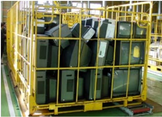
プラントに搬入された時の状態です。ブラウン管が割れないよう、コンテナに積み込まれています。
