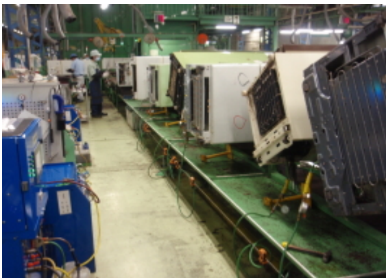
冷媒回収機で冷媒フロンを回収します。回収された冷媒フロンは、専門処理施設で処理されます。
