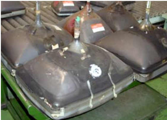
取り外されたブラウン管です。ブラウン管は分割・破碎・洗浄(乾式)され、ガラスとして再利用されます。
