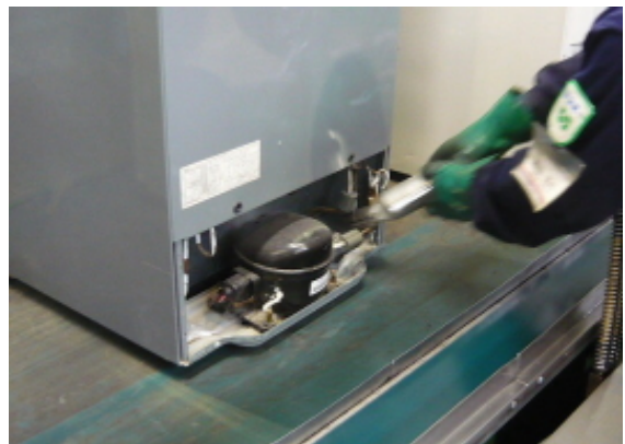
冷媒フロン回収後、パイプを切断し、コンプレッサーを取り外します。
