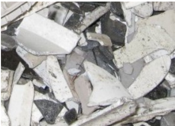
回収されたプラスチックです。プラスチックは、素材の再利用のため、種類ごとに選別されます。
