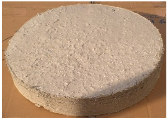
回収されたウレタンです。冷蔵庫の断熱材として使用されていたものを微粉碎後に圧縮したものです。断熱材内のフロンは密閉した粉碎機の中で回収されます。
