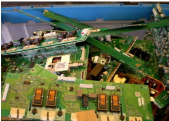
液晶テレビから取り外された基板です。専用処理施設でリサイクル処理されます。
