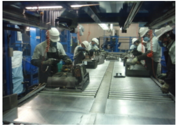
最初に背面カバーを取り外し、次にブラウン管や基板などを手作業で取り外します。
