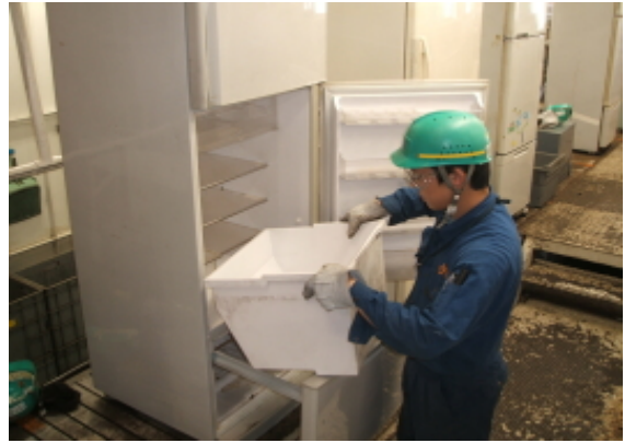
野菜ケースなどのプラスチック部品を手作業で取り外します。
