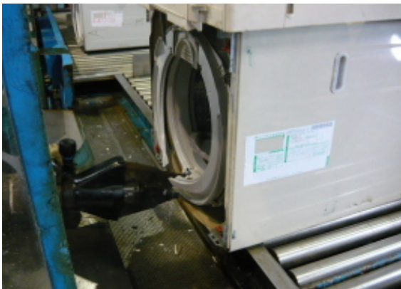
破碎機やリサイクルされる金属の錆防止のため、洗濯槽上部のリング部に入っている塩水を、切断機などを使って抜いておきます。
