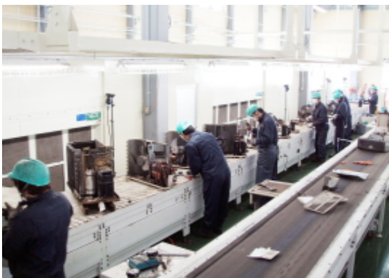
冷媒回収後、室外機から、基板やコンプレッサー、熱交換器などを手作業で取り外します。
