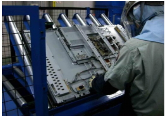
大型の液晶テレビは、専用作業台で効率的に解体されます。
