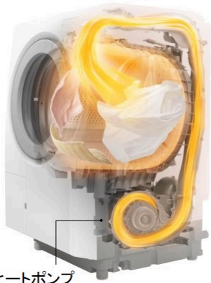
BD-STX130J_ヒートポンプ式構造図 (イメージ図)
