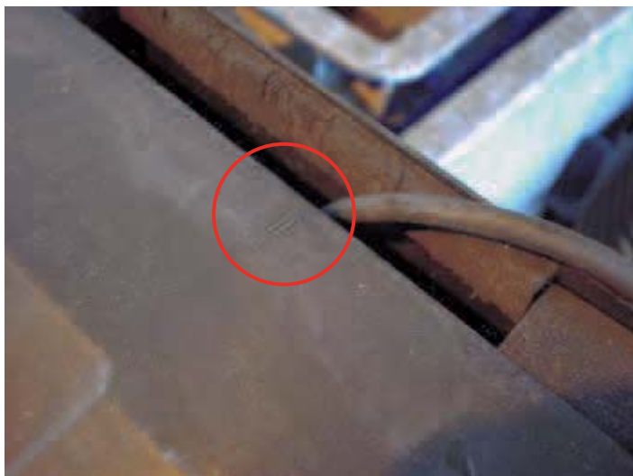
図 5-2-9. テレビの取り外しねじのマーク表示
