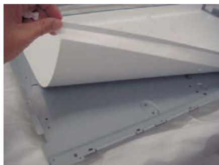
反射シートのテープ止めを廃止した例
