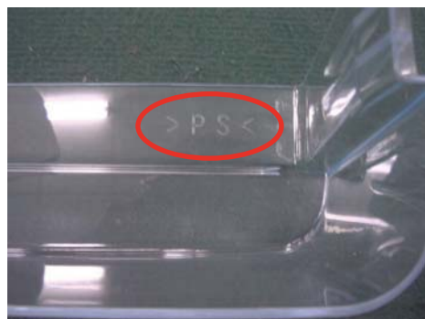
冷蔵庫ドアポケットの材質表示例
