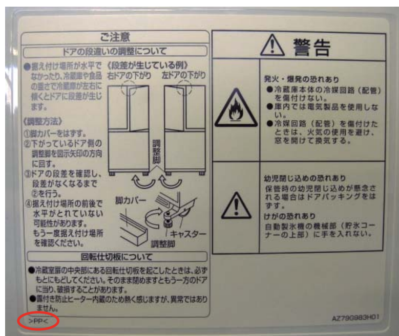
ラベルの材質表示の例
