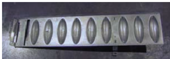
ステンレスと思われるが表示がなく材料が不明確な金属部品の例
