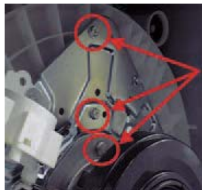
ねじを六角ボルト化し、取り外しを容易にした例
