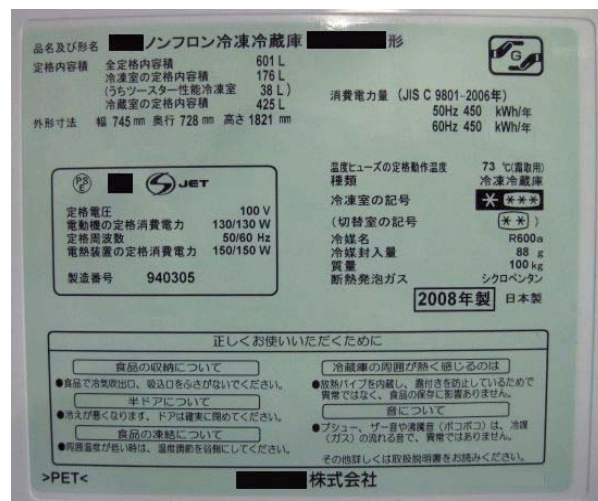
冷蔵庫ドア内側の品質表示ラベルの例
