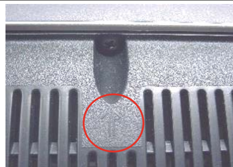
取り外しねじのマーク表示の例
