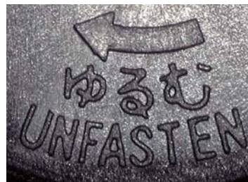
取り付けねじ回転方向表示の例
